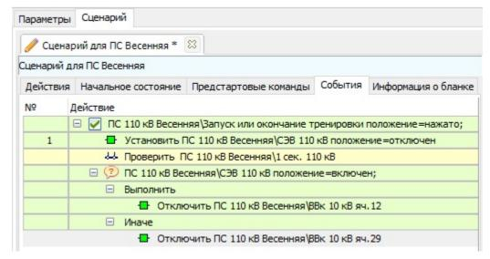
Рис. 66. Результат заполнения строк "Выполнить" или "Иначе"
