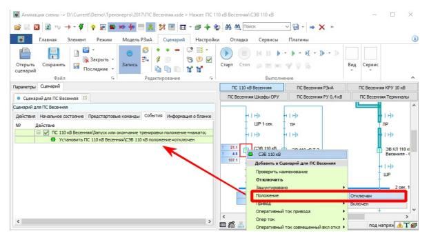
Рис. 61. Добавление последствия в событие
