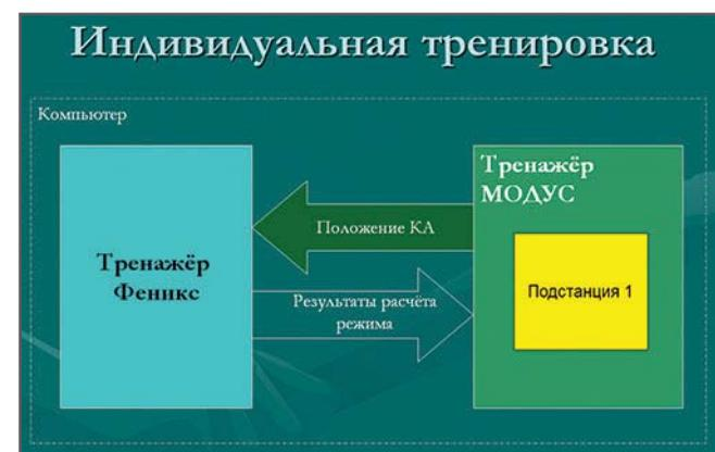
При выполнении коллективной тренировки несколько пользователей работают с одним общим экземпляром тренажёра Феникс и с индивидуальными экземплярами тренажёра МОДУС, при этом пользователи могут выполнять переключения на разных подстанциях, имитируя работу дежурных на подстанции или ОВБ.
