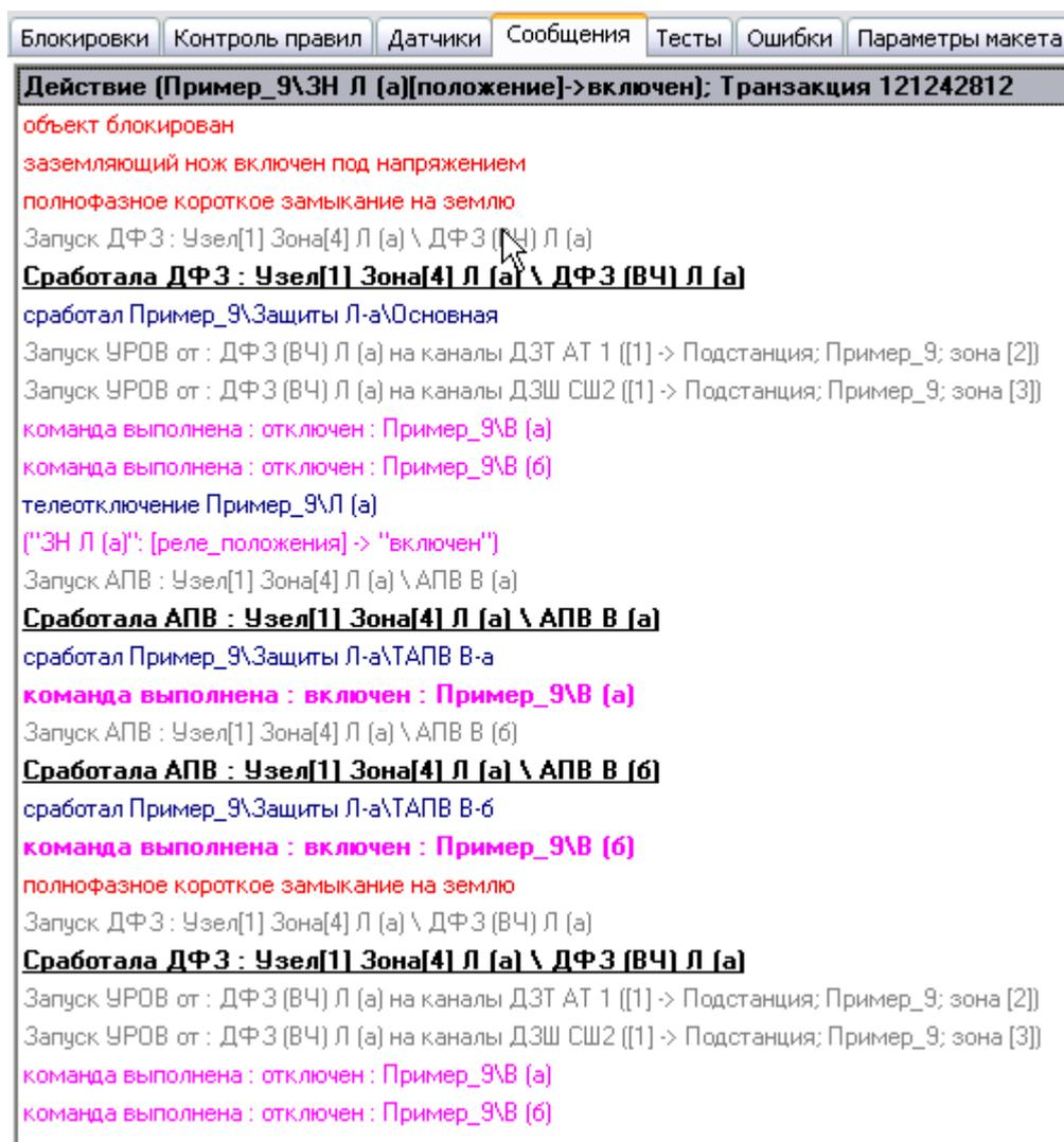
Рис. 5-107. Протокол работы основной защиты линий
