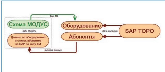
Вариант стыковки Модус и SAP через выгрузки
