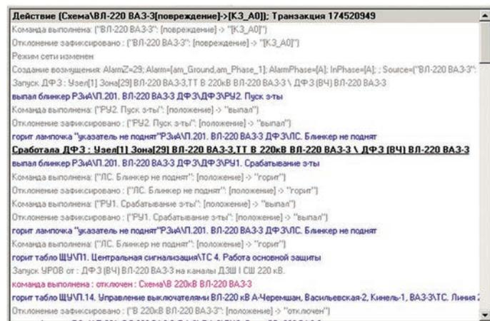
Протокол работы модели защит при КЗ в схеме
