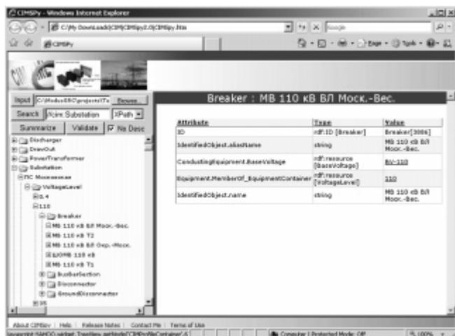
Рис. 4. Просмотр данных СИМ-модели, полученной из схемы, подготовленной в графическом редакторе
